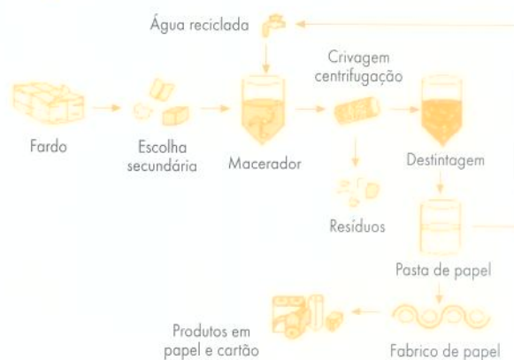
Figura 18 • Processo de Reciclagem do Papel
