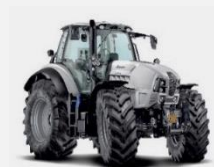
Trator agrícola com proteção ROPS na cabina
